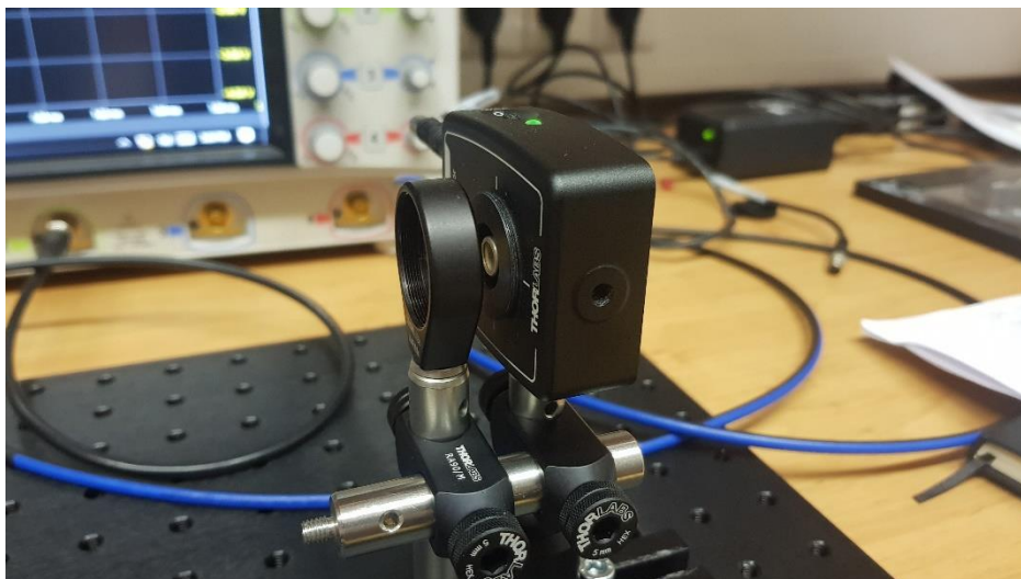
Obrázek 26 – Čočka pro usměrňování světla do fotodiody
